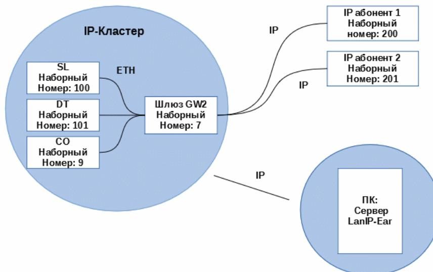
Рис. 5. Пример постановки на регистрацию абонентов IP-Кластера.
