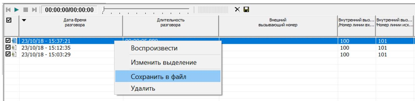
Рис. 23. Сохранение записи архива в отдельный файл
