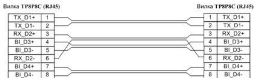
Рис. 1. Кабель для подключения модуля к ETHERNET коммутатору
