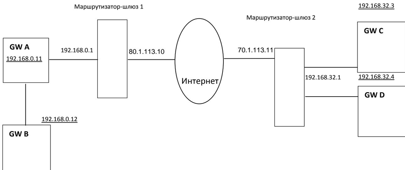
Этот пример отличается от предыдущего тем, что за маршрутизатором-шлюзом 2, в одной локальной сети находятся два модуля GW (GW C и GW D), осуществляющие соединения через Интернет **по протоколу SIP** с модулем GW A.
