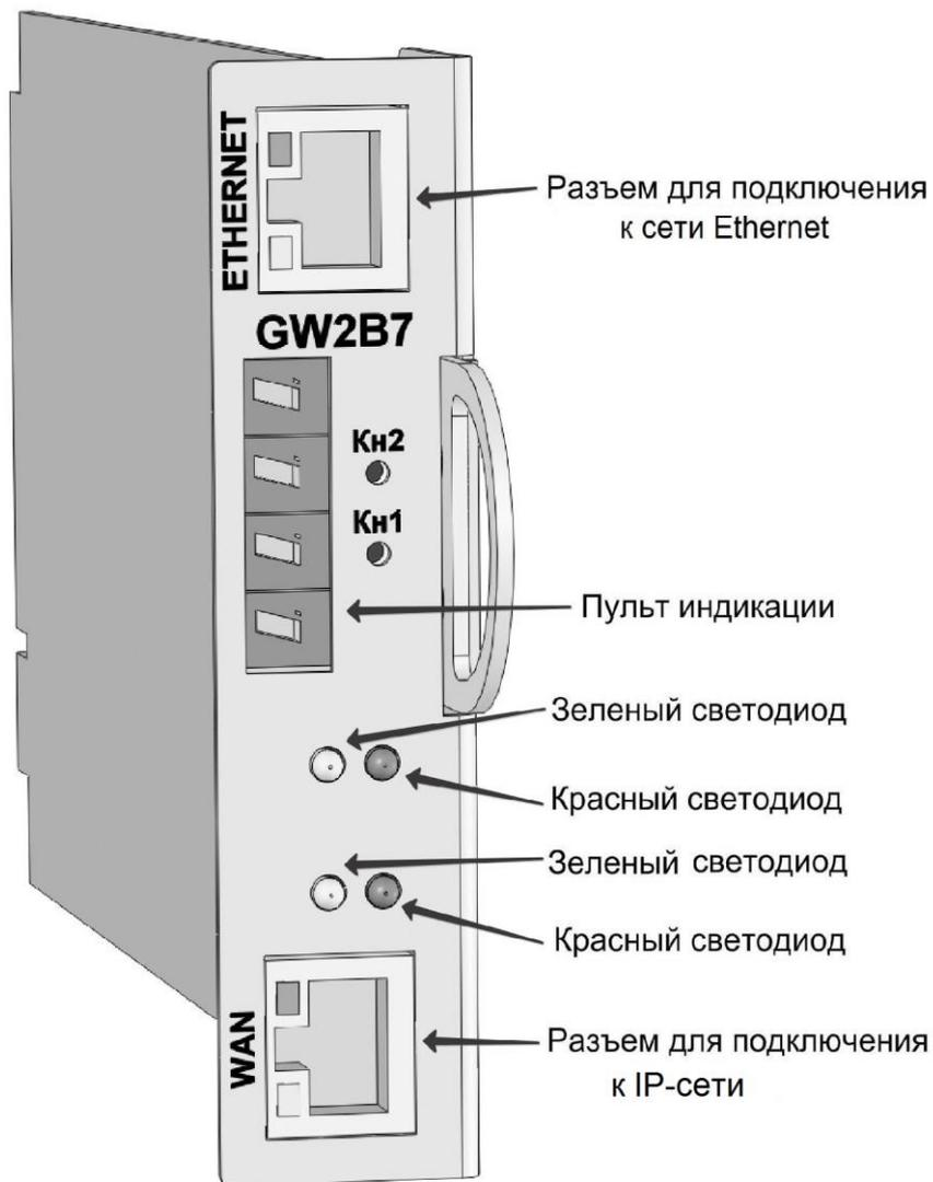
Разъём **ETHERNET** должен быть подключён к тому коммутатору, к которому подключены остальные DXE-модули.
