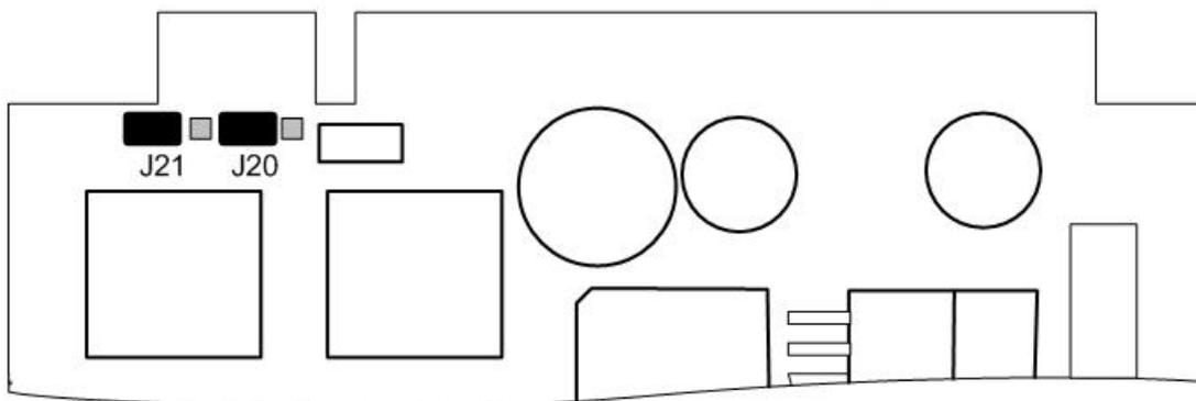
Рис. 11. Установка перемычек на модуле SMB7-04 для выбора способа подачи вызывного напряжения
