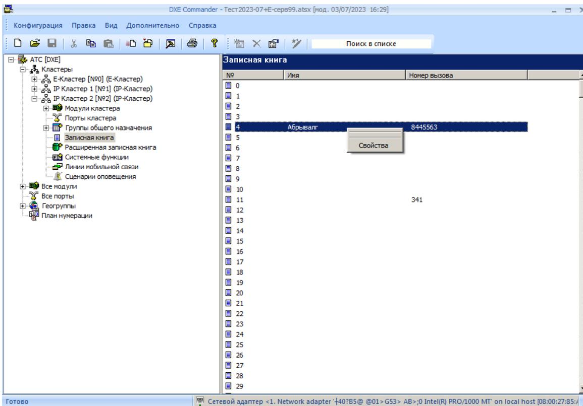
В открывшемся окне указаны параметры ячейки записной книги: наименование ячейки, префикс вызова и номер вызова. Префикс используется для выхода на внешнюю линию. Линии,
