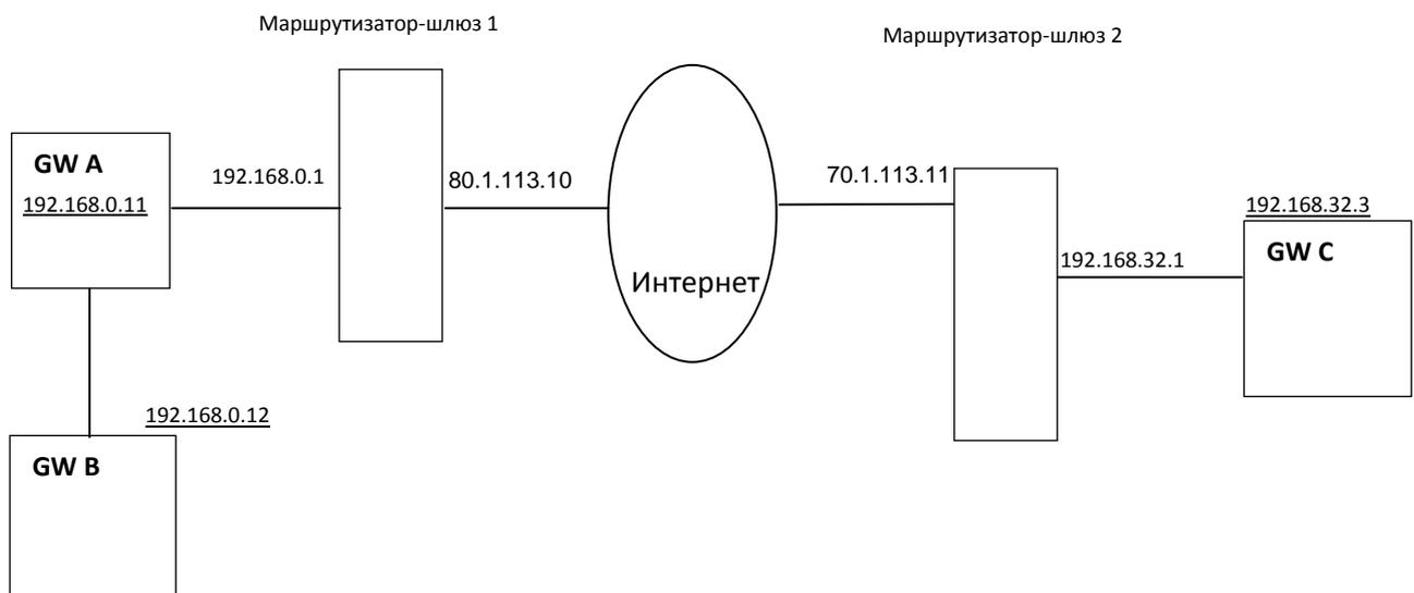
В этом примере модули GW имеют следующие значения параметров конфигурации, обеспечивающие возможность соединений **по протоколу SIP или H.323** между модулями GW A и GW B, находящимися в одной IP-сети, и между модулями GW A и GW C, находящимися в разных IP-сетях, соединённых через Интернет.
