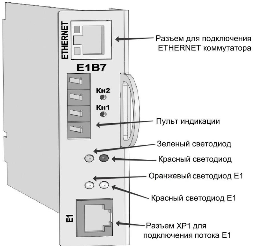
Рис. 15. Модуль E1B7
