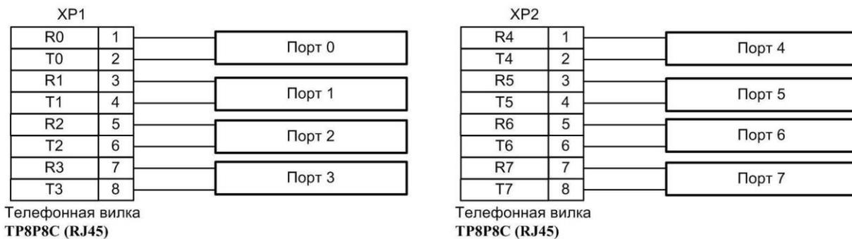
Рис. 4. Схема кабеля для подключения окончных абонентских устройств
