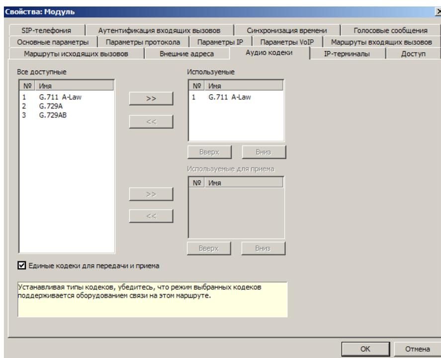
В таблице **«Используемые»** приведён упорядоченный список аудио-кодеков, используемых в АТС «РЕГИОН-DXE» при установлении телефонных соединений. Чем ближе к началу списка указанный в списке кодек, тем предпочтительнее его использование.
