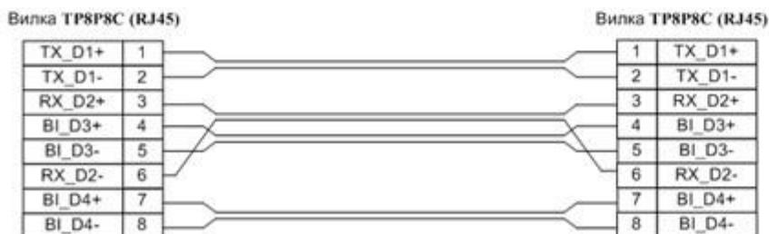
Рис. 1. Кабель для подключения модуля к ETHERNET коммутатору
