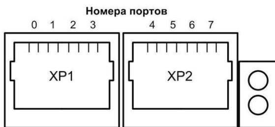
Рис. 23. Разъемы модуля KIP-SLB7 для подключения абонентских линий
