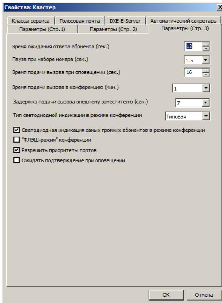
"Время ожидания ответа абонента" – время в течение которого ожидается ответ от вызываемого абонента. Этот параметр определяет время перевода звонка «по не ответу» на заместителя и при звонках на последовательную группу. При оповещении этот параметр определяет время, до истечения которого оповещаемый абонент должен отправить сигнал подтверждения о прослушивании голосового сообщения.
