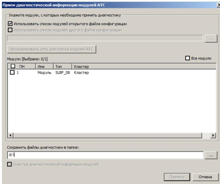
В появившемся окне необходимо выбрать модули, с которых будет сниматься диагностическая информация, и путь к папке для сохранения диагностической информации. Имена файлов диагностической информации генерируются автоматически на основе номера и типа модуля. При выборе более одного модуля, по указанному пути автоматически создается вложенная папка.
