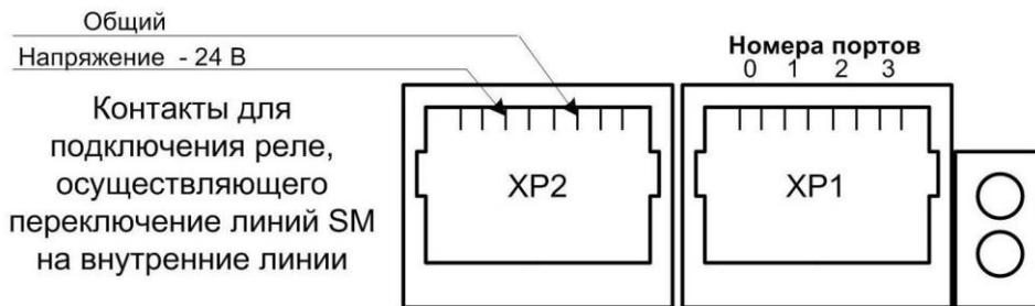
Рис. 9. Разъемы модуля SMB7-04 для подключения линий SM
