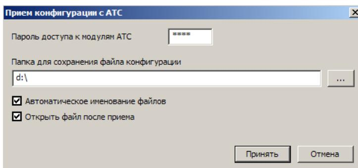
Опция «**Автоматическое именование файлов**» включает автоматическое назначение имени файла при приеме конфигурации с АТС. При включенной опции, пользователем указывается только папка для сохранения конфигурации, имя файла создается автоматически, на основе имени АТС и текущей даты-времени на момент приема конфигурации. Файлам конфигурации, принятым в режиме автоматического именования файлов, назначается атрибут <Только для чтения>.
