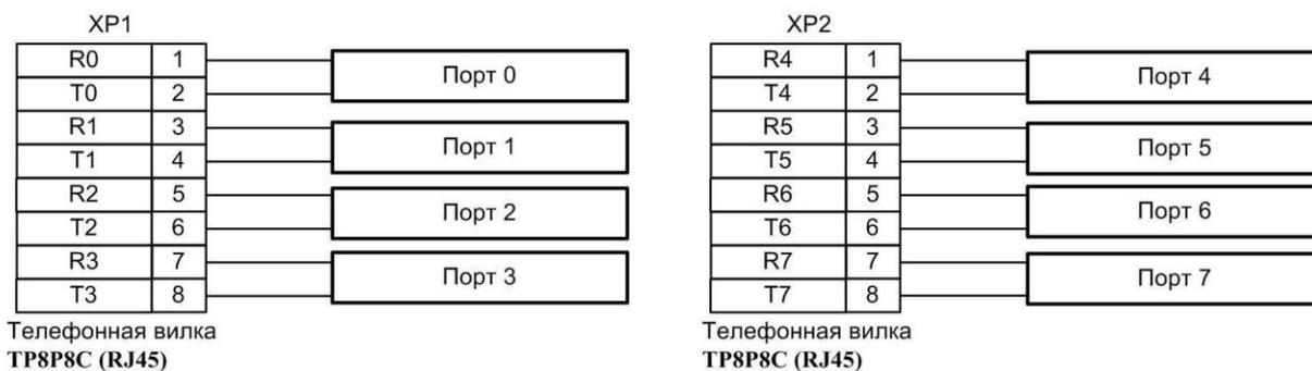
Рис. 24. Схема кабеля для подключения оконечных абонентских устройств
