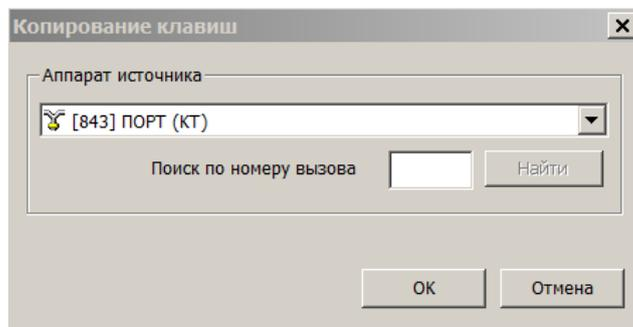
После выбора аппарата источника копирования клавиш, будут скопированы все клавиши с аппарата источника и его внутренних (физически подключенных к аппарату) консолей. Следует иметь в виду, что назначения клавиш не могут повторяться на аппарате и его консолях.
