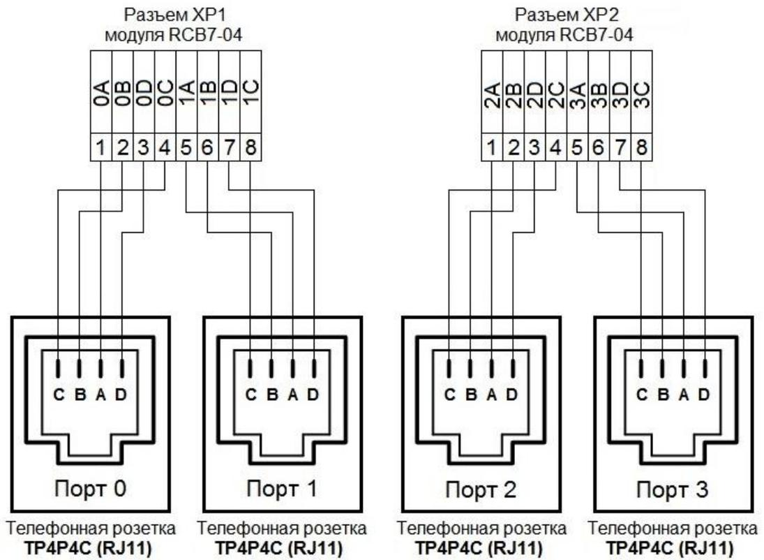
Рис. 14. Подключение системных аппаратов к модулю RCB7-04
