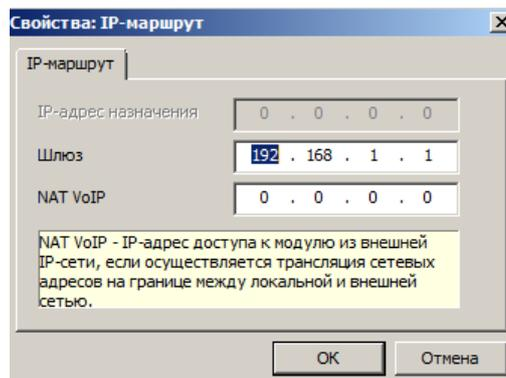
В окне «**IP-адрес назначения**» набрать требуемый IP-адрес назначения (для 0-й строки – IP-адрес назначения не набирать), в окне «**Шлюз**» - IP-адрес маршрутизатора, в окне «**NAT VoIP**» - значение NAT VoIP, и нажать «**ОК**».
