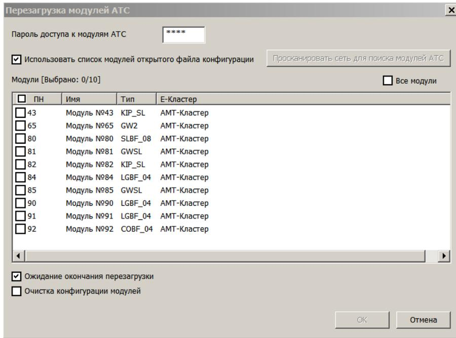
В появившемся окне необходимо выбрать модули, пароль доступа к модулям и указать дополнительные параметры. Опция **“Ожидание окончания перезагрузки”** включает режим ожидания окончания полной перезагрузки модулей. Для сброса конфигурации указанных модулей на значения по умолчанию, необходимо включить опцию **“Очистка конфигурации модулей”**.
