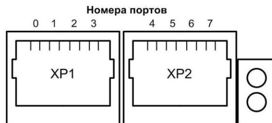
Рис. 3. Разъемы модуля SLB7-08 для подключения абонентских линий
