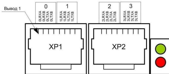
Рис. 26. Разъемы модуля TFB7-04 для подключения абонентских линий
