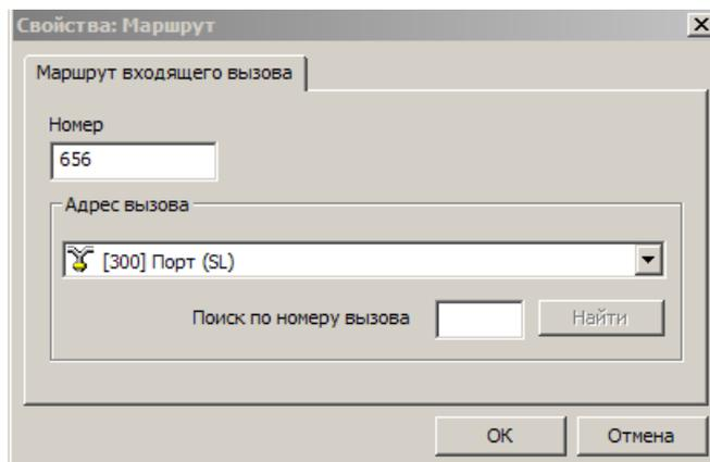
В поле «**Номер**» указать требуемый (набираемый вызывающим абонентом) номер вызова, в окне «**Адрес вызова**» выбрать из предлагаемого списка объект (наборный номер конкретного абонента, группы внутренних абонентов, сервисной функции), который следует вызывать при поступлении этого номера во входящем вызове, и нажать «**ОК**».
