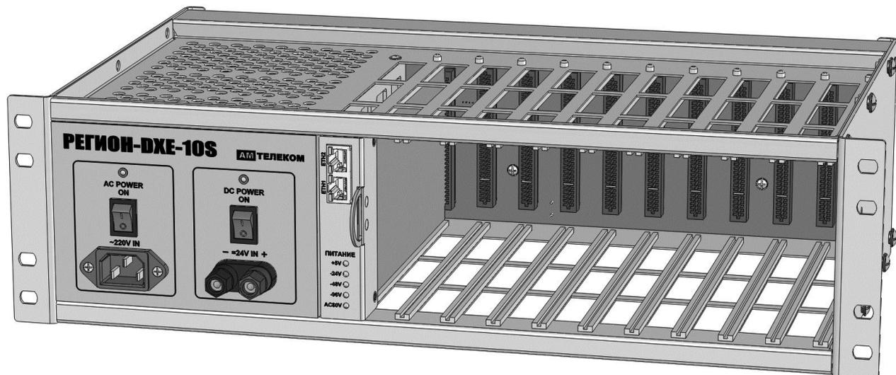
Питание таких базовых блоков осуществляется от однофазной сети  $\sim 88...264\text{В}$  частотой  $47...63\text{Гц}$  или от постоянного напряжения  $23...27\text{В}$ .
