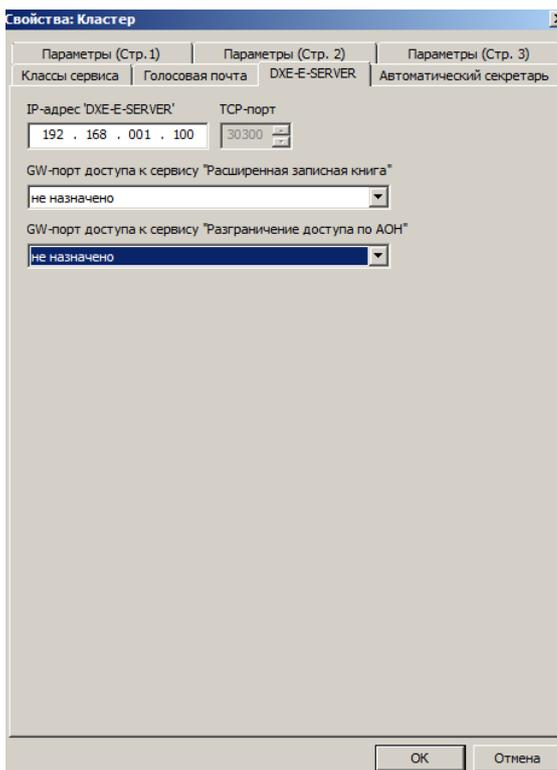
На закладке "**DXE-E-SERVER**" отображаются параметры связи с модулем 'DXE-E-SERVER' для этого Кластера. Многоцелевой [модуль 'DXE-E-SERVER'](#) используется для реализации [расширенных сервисов ATC](#) и архивации разговоров (LANIP-EAR/DXE).
