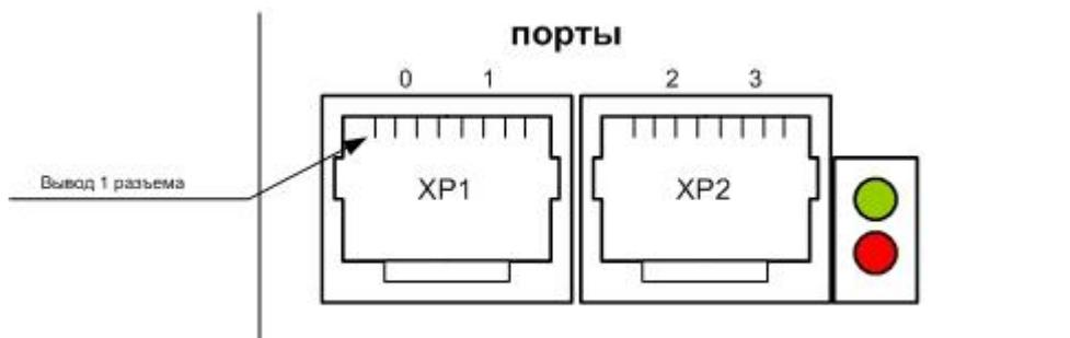
Рис. 33. Разъемы для подключения звуковых каналов 10-проводных стыков
