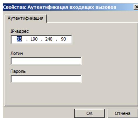
Аутентификации входящих вызовов реализована в АТС «РЕГИОН-DXE» только для протокола SIP. Для выполнения аутентификации входящих вызовов следует включить опцию <Аутентификация входящих вызовов> на закладке <Параметры протокола>.
