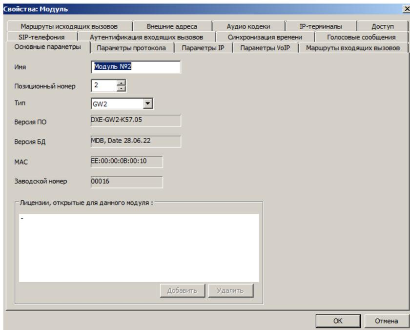
При добавлении модуля, портам модуля, в зависимости от их типа, автоматически будут назначены свободные номера вызова. Для внешних линий (CO) нумерация начинается с номера 100. Для системных аппаратов (КТ) с номера 200. Для стандартных аппаратов (SL) с номера 300.
