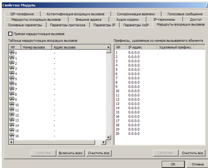
Следует иметь в виду, что сервисным системным функциям, назначаемым как адрес вызова, должны быть присвоены номера вызова.
