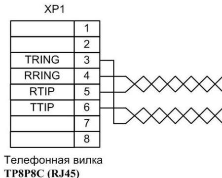
Рис. 17. Схема кабеля для подключения потока E1
