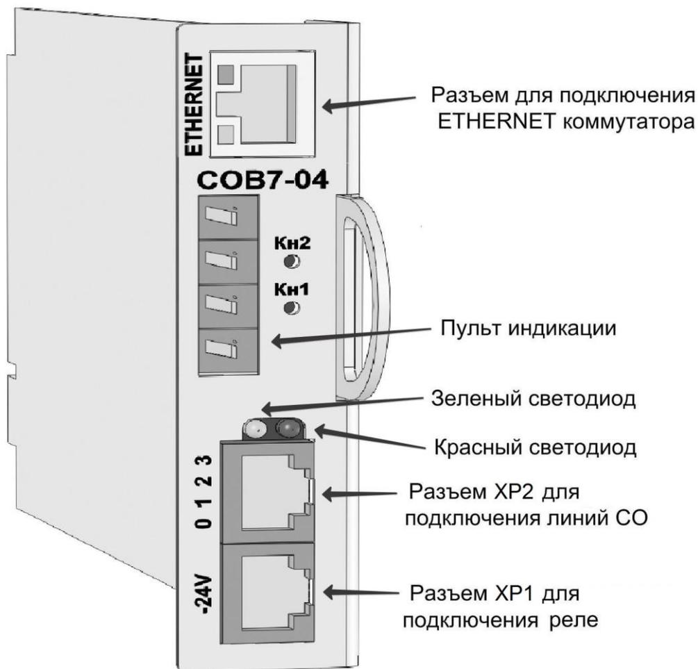
Рис. 5. Модуль COB7-04
