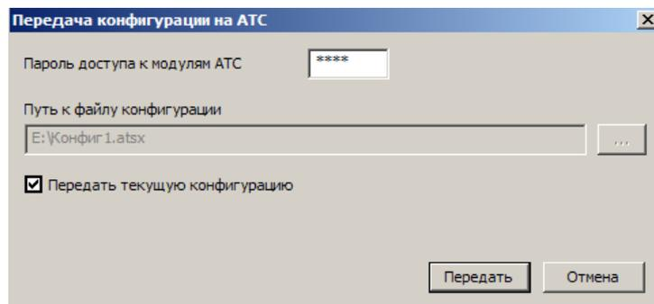
В появившемся окне "Передача конфигурации на АТС" выбрать нужную конфигурацию, указать текущий пароль доступа к модулям и нажать клавишу "ОК". Заводское значение пароля доступа к модулям <0000>.
