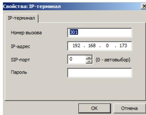
Набрать требуемый наборный номер IP-терминала, его IP-адрес и/или пароль, требуемый номер SIP-порта. Нажать «ОК».
