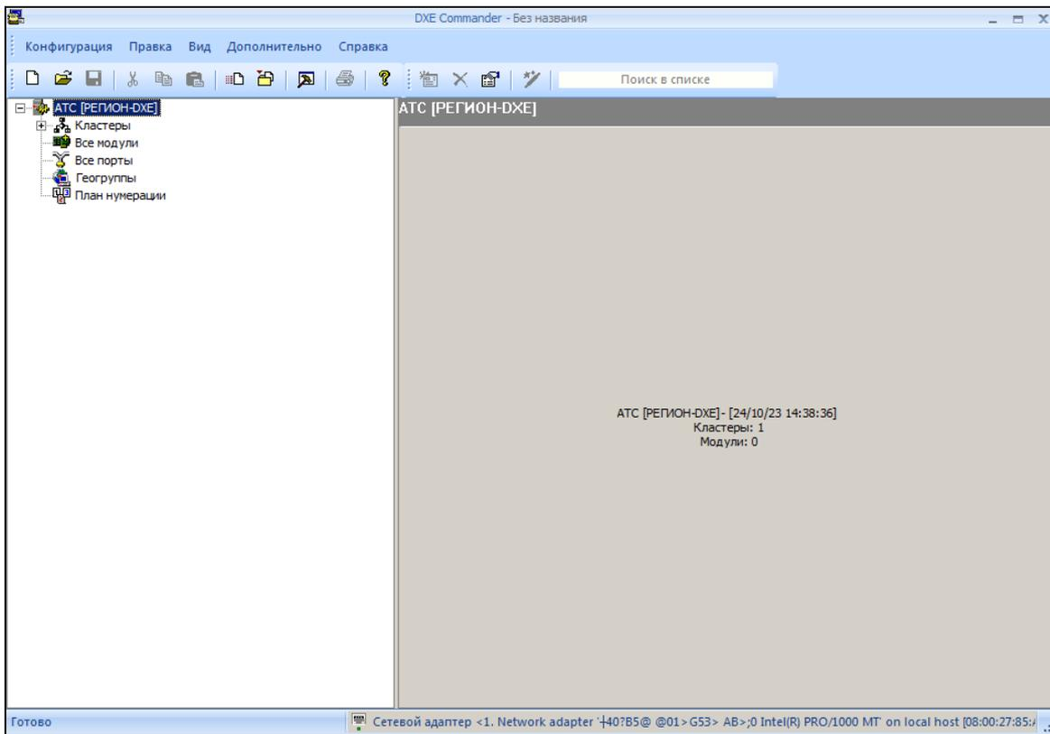
При запуске программы автоматически создается новая пустая конфигурация. Имеется возможность вручную создать новую конфигурацию или загрузить текущую конфигурацию непосредственно с АТС «РЕГИОН-DXE» (рекомендуется). При первом запуске необходимо выбрать сетевой адаптер ETHERNET, посредством которого производится конфигурирование АТС. Выбор сетевого адаптера осуществляется в меню <Правка> - <Настройки ПО> - <Сетевой адаптер> (см. раздел [Установка общих параметров ПО «DXE Commander»](#)).
