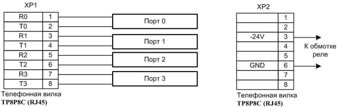
Рис. 7. Схема кабеля для подключения оконечных абонентских устройств
