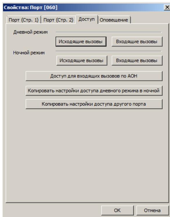
Для SL-портов типа **ДАТЧИК** доступны только **разрешающие** группы доступа.
