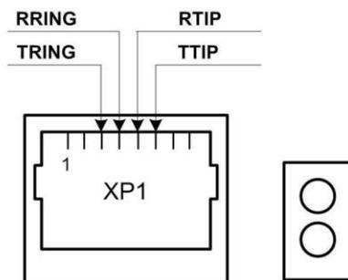
Рис. 16. Разъем модуля E1B7 для подключения потока E1
