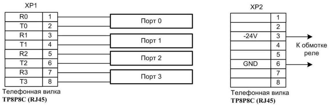
Рис. 10. Схема кабеля для подключения оконечных абонентских устройств
