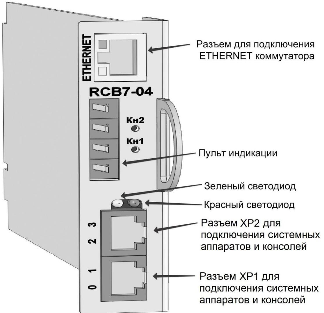
Рис. 12. Модуль RCB7-04
