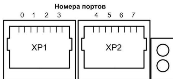
Рис. 20. Разъемы модуля GWSLB7 для подключения абонентских линий
