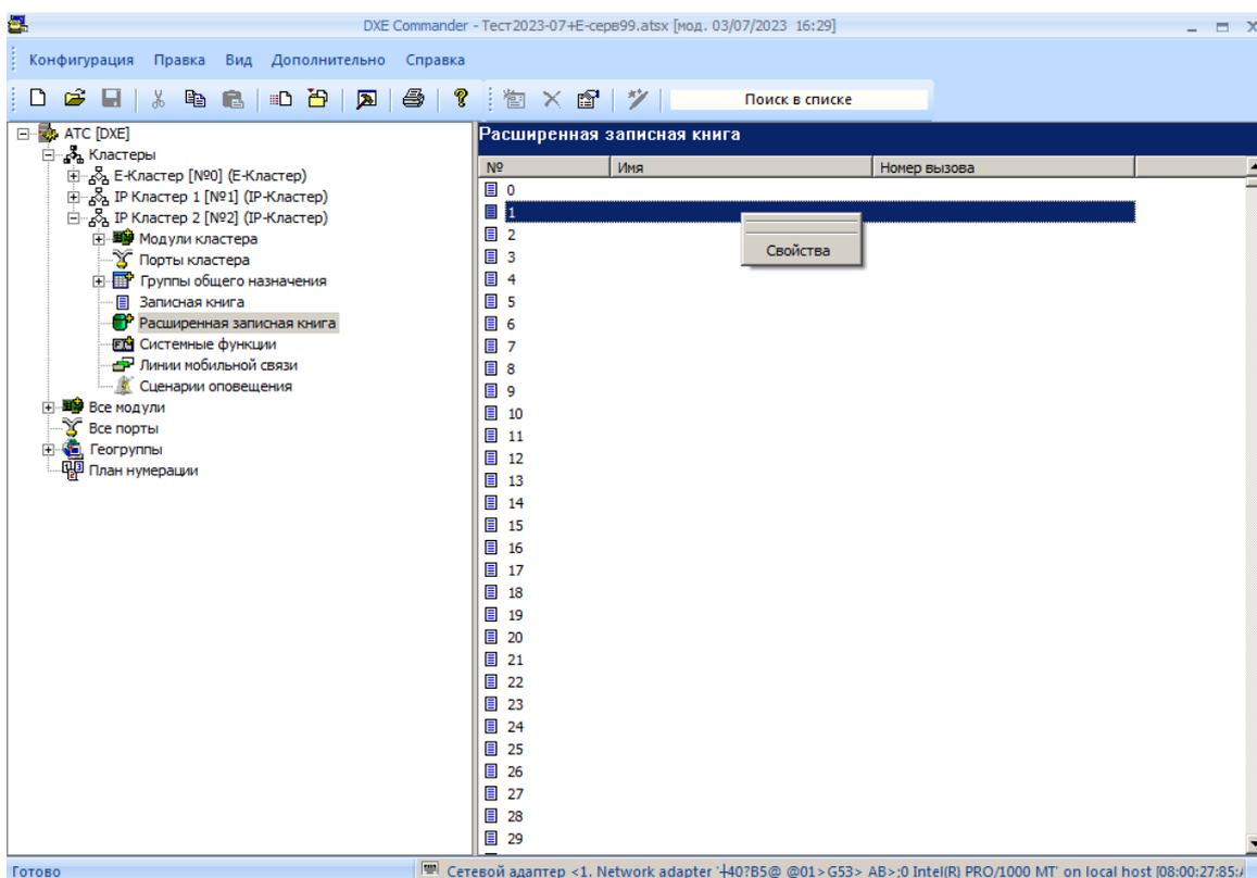
В открывшемся окне указаны параметры ячейки записной книги: наименование ячейки, префикс вызова и номер вызова. Префикс используется для выхода на внешнюю линию. В качестве префикса для ячеек расширенной записной книги могут быть указаны наборные номера линий СО, Е1 и GW-портов любых модулей GW.
