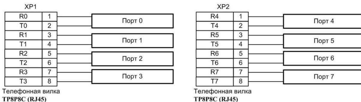
Рис. 21. Схема кабеля для подключения оконечных абонентских устройств
