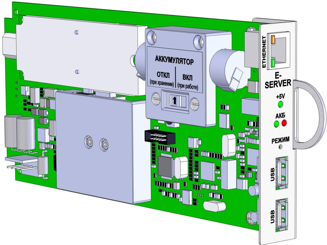
Модуль 'DXE-E-SERVER' используется для работы [расширенных сервисов АТС](#) и для системы архивации разговоров 'LanIP-Ear/DXE' в АТС «РЕГИОН-DXE». Для функционирования расширенных сервисов АТС и системы архивации разговоров 'LanIP-Ear/DXE', кроме наличия модуля 'DXE-E-SERVER', требуется приобретение лицензии (см. [Лицензии на расширенные сервисы](#) и [установка лицензии 'LanIP-Ear/DXE'](#)).
